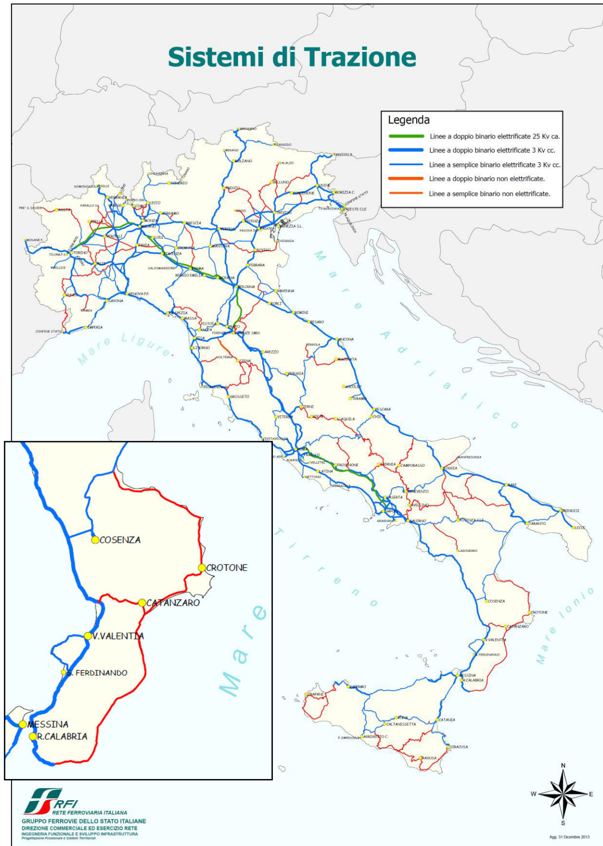
Fig. 2.4.30 - Sistema di alimentazione e numero binari sulla rete ferroviaria calabrese e italiana. Aggiornamento dicembre 2013 (Fonte: R.F.I., www.rfi.it )
